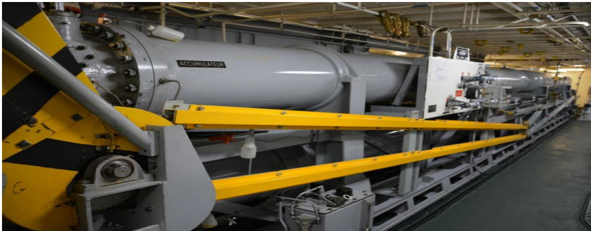
L'une des trois presses de frein (© : MER ET MARINE - VINCENT GROIZELEAU)
