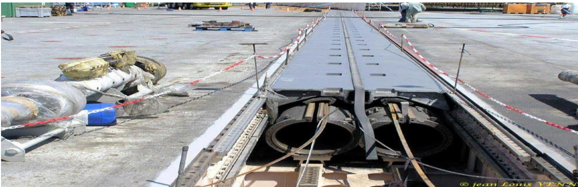
Vue des deux lignes de cylindres de la catapulte avant lors de sa révision en 2008 (© : MER ET MARINE - JEAN-LOUIS VENNE)
