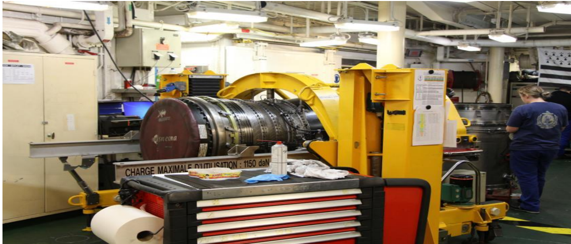
Banc de maintenance de réacteur M88, décembre 2018 (© : MER ET MARINE - MATTHIAS ESPERANDIEU)
